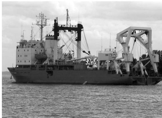
*Судно-килектор БФ «Александр Пушкин» предназначено для постановки-съемки боно-сетевого заграждения и рейдового оборудования, расчистке и разметке фарватера, а также различных гидротехнических работ.*
